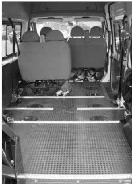
Na podlaze mikrobusu jsou kotvící prvky pro bezpečné uchycení přepravovaných vozíků.
