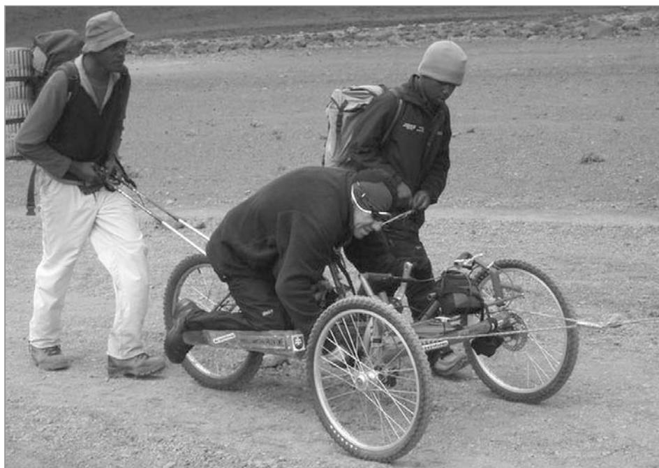
Styl posedu na Lacově horském speciálu handbiku – na břiše. To kvůli rozložení těžišť. Zlepší tak zatížení na přední kola. Proto Laco může lépe zdolávat velmi prudké výjezdy vlastní „ruční“ silou.
