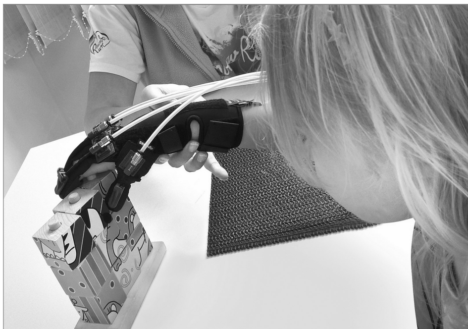
Rehabilitační přístroj Gloreha – robotická rukavice pro rehabilitaci rukou pacientů s neurologickými či posttraumatickými poškozeními
