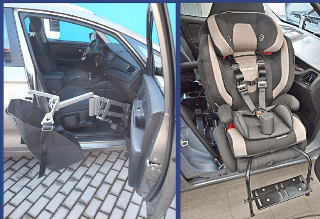
Dětský zádržný systém Recaro Monza s úpravami PROTEC METAL. Splňuje dynamické zkoušky dle předpisu EHK 44 04
