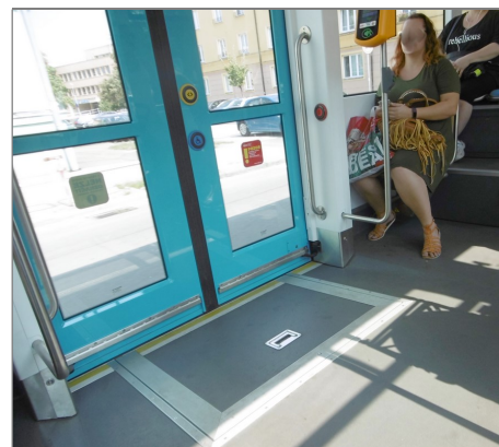
Dveře s ovládacími prvky, u kterých se nachází mechanicky sklopná nájezdová rampa v mírně sešikmené podlaze
