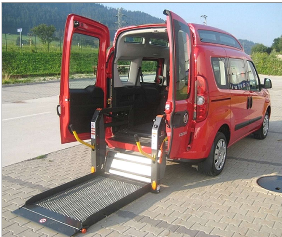
Zapůjčené vozidlo Fiat Doblo má také zvedací plošinu umožňující naložit vozíčkáře z chodníku či cesty přímo bez přesezení
