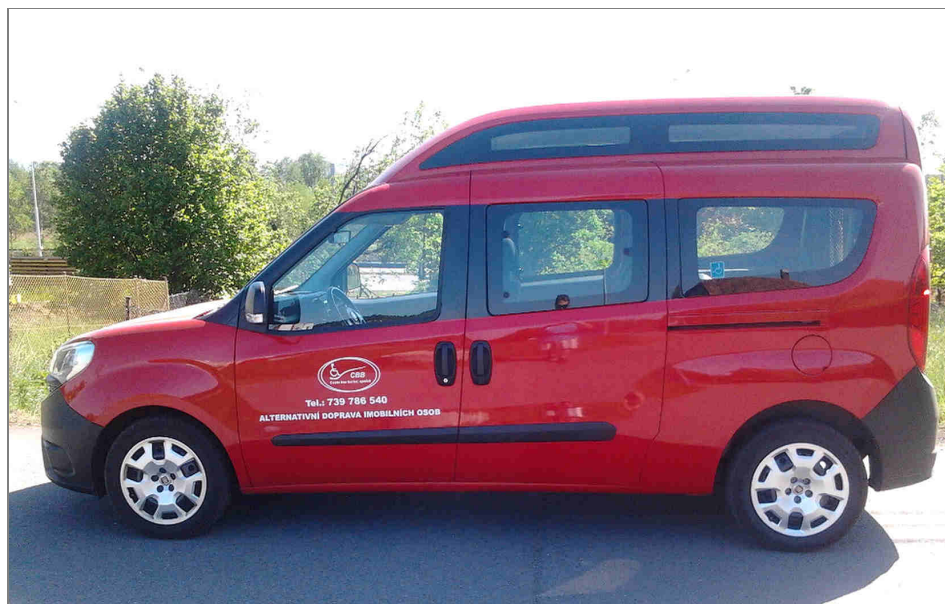
Červený Fiat DOBLÓ prošel úpravou pro převoz vozíčkářů, mj. zvýšením střechy
