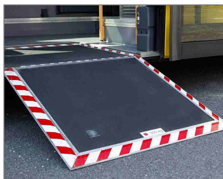
Nájezd do bus Iveco Crosway společnosti TQM
