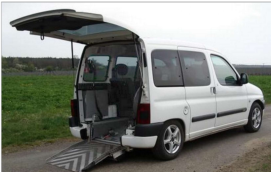
Díky šikmé nájezdové rampě a kotvicím prvkům pro vozík může být vozíčkář přepraven bez přesedání
