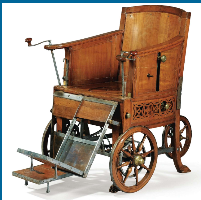
Kolečkové křeslo s mechanickým pohonem předních kol. Kolový podvozek je opatřen zdvihem, umožňujícím křeslu stát napevno na nohách. (Období Ludvíka XVI)
