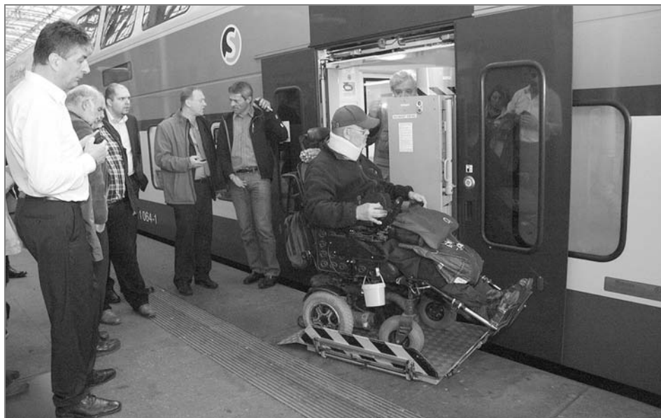
Ukázka naložení vozíčkáře na elektrickém vozíku prostřednictvím zvedací plošiny do příměstského vlaku CityElefant. Vozíčkářem na snímku je častý uživatel vlaku a aktivista a konzultant v otázkách vlakové dopravy Ivo Krajiček z Jihlavy
