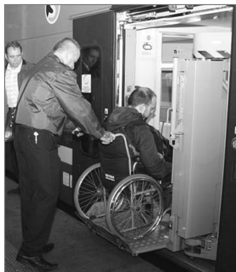
Z ukázky naložení vozíčkáře na mechan. vozíku prostřednictvím zvedací plošiny do příměstského vlaku CityElefant
