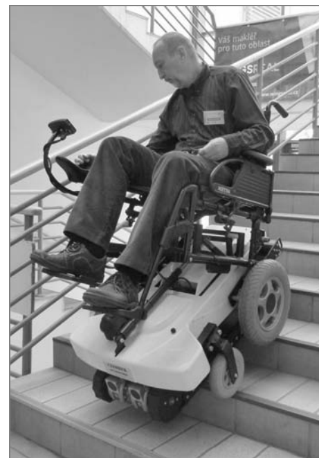
Samoobslužný schodolez Climber automatic fy Horizont-Nare kombinuje schopnosti mechan. vozíku a schodolezu. V automatickém modu na schody najíždí zcela automaticky. Jeho sedadlo i opěrka jsou naklápěcí. Úřad práce jej může hradit do výše 400 000 Kč, doplatek pak činí cca 100 000 Kč
