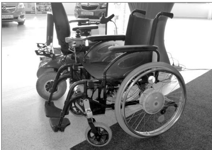
Mechanický vozík s dopomocným pohonem v zadních kolech ostravské firmy Postelova.cz za pouhých 17 000 Kč. Baterie je umístěna vpředu pod sedadlem. Dopomocným pohonem firma vybaví jakýkoli mechanický vozík
