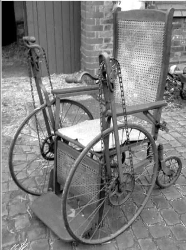
Vozík pro invalidy fy Gendron Wheel Copany, USA, r. 1898: ruční řetězový pohon, odpružená sedačka, sklápění opěradla
