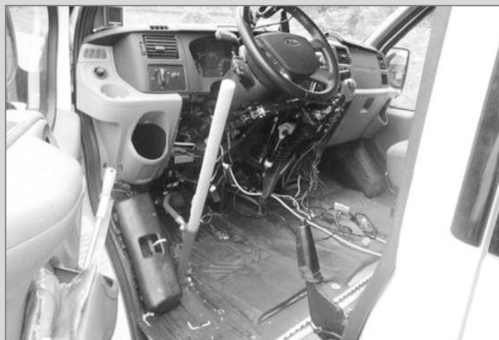
Dočasný nouzový prostředek pro ovládání pedálu spojky – násada na smeták
