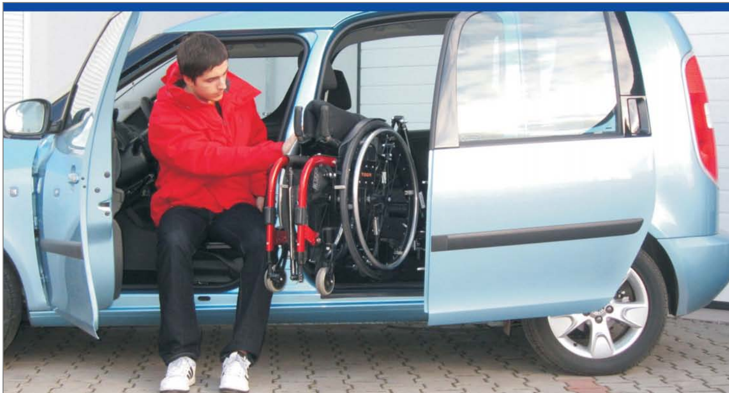
Nakladač vozíku do odsuvných dveří - oceněný exponát na veletrhu Reahaprotex 2013 v Brně
