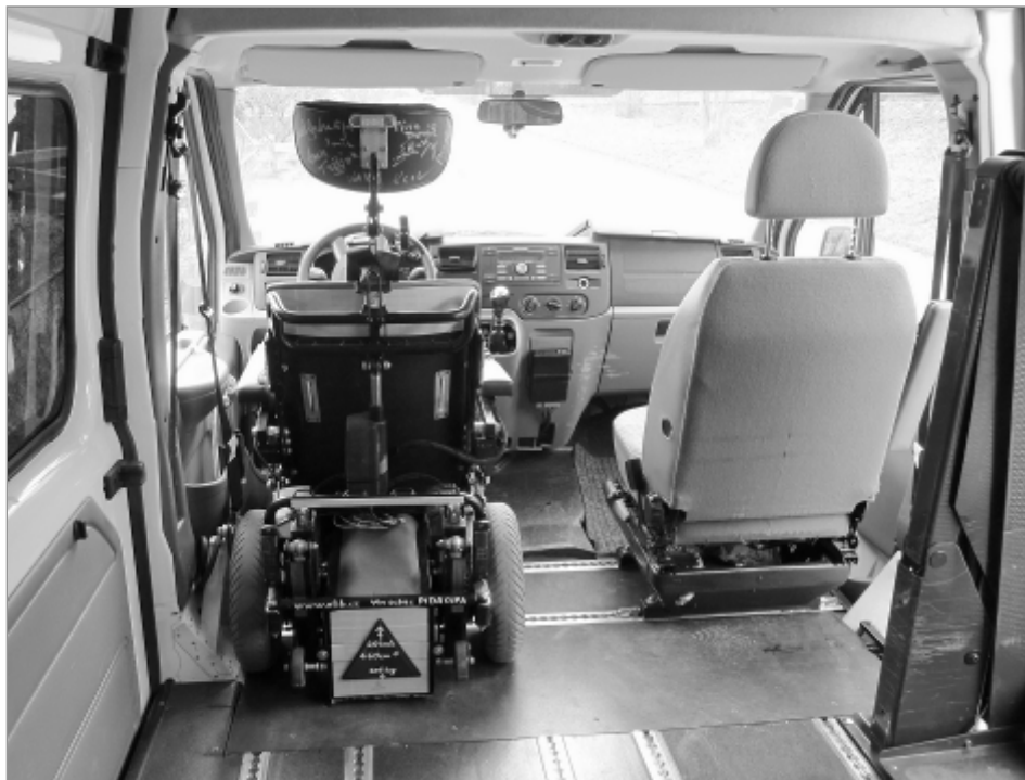
Upravený elektrický vozík umožňuje zajet až k volantu dodávky a automaticky se ukotvit do podlahy.
