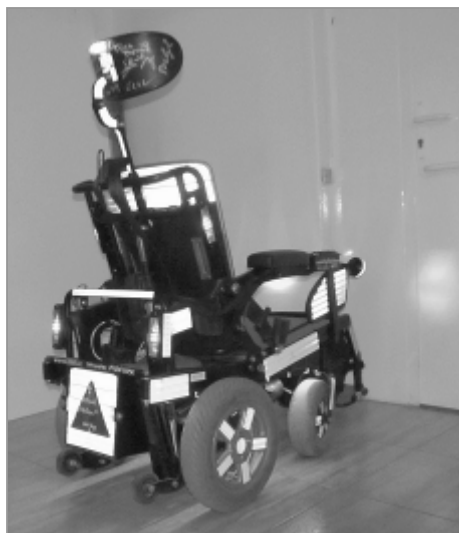
Reflexní samolepky, přední a koncové osvětlení a podsvícení šasi dělá z vozíku ve tmě na vozovce nepřehlédnutelný objekt.
