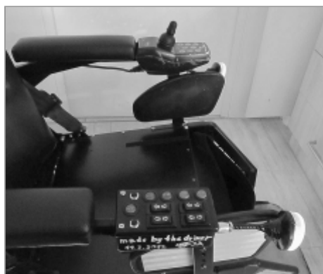
Na levé područce je standardní ovladač el. vozíku, na pravé pak ovladač pro nadstandardní funkce.
