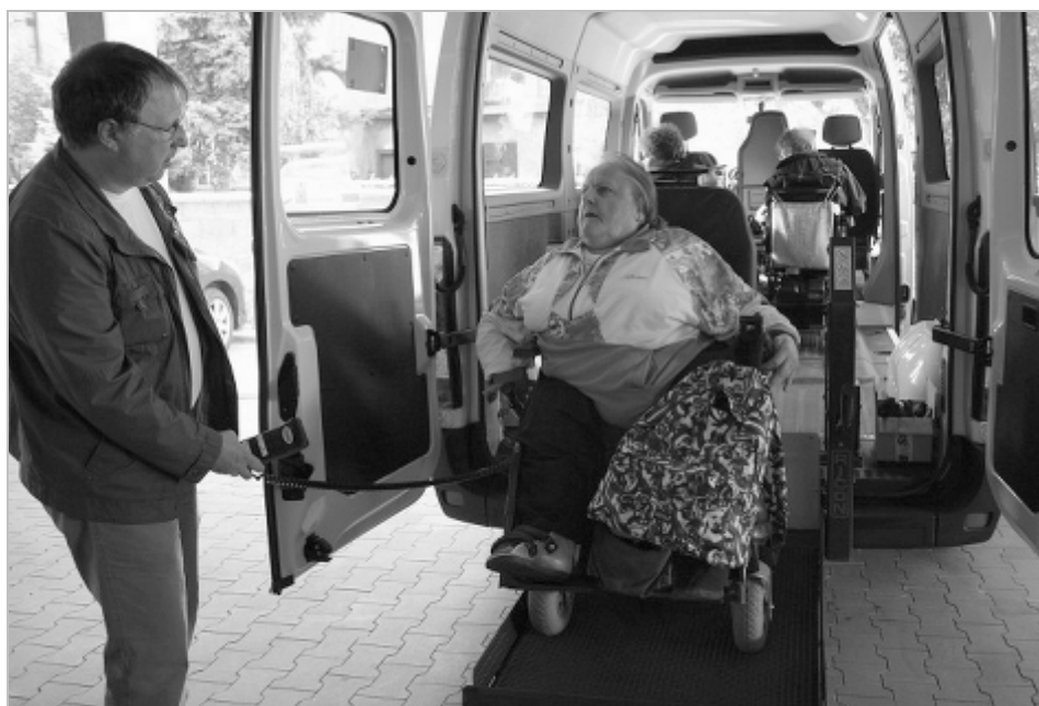
Automobil Renault Master je vybaven hydraulickou zdvižnou plošinou
