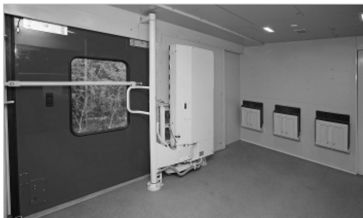
Nástupní prostor se zdvižnou plošinou pro nástup vozičkářů
