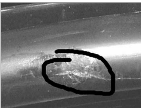
Trhlina na pogumované obruči po zalpení před přebroušením.
