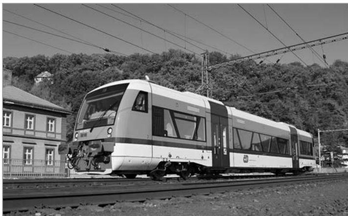
Částečně nízkopodlažní motorový vůz RegioShuttle RS 1.
