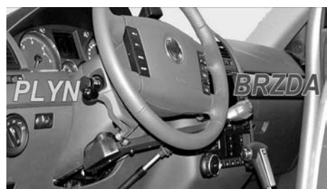
Páčkový plyn 905 s klasickou brzdovou pákou pod volantem 907.
