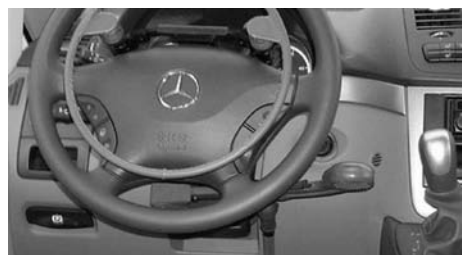
Klasická brzdová páka 907 kombinovaná s elektronickým plynem 906 GV.
