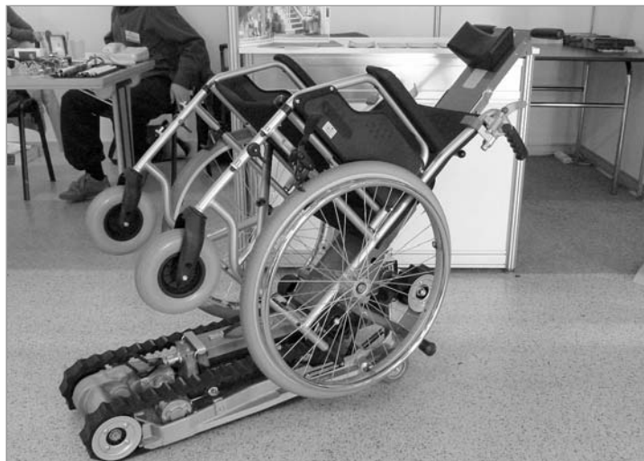
Pásový schodolez od fy Altech, spol. s r.o. umí překonávat jednotlivé schody i celá schodiště.
