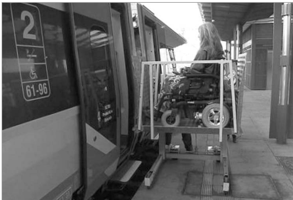
Od prosince 2011 by RegioJet měl mít nové vagony s integrovanou zvedací plošinou. Nakládání vozíčkářů pomocí mobilních zvedacích plošin (viz foto) tak odpadne.
