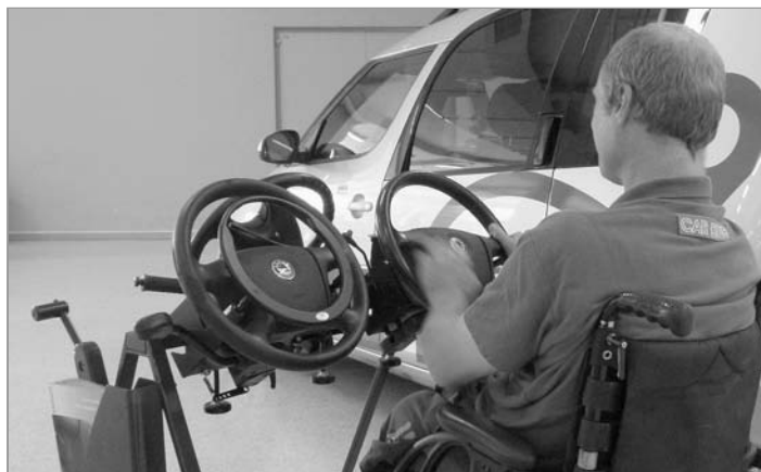
Na demonstračním stojanu si mohli návštěvníci vyzkoušet několik typů ručního ovládání automobilu fy Josef Hurt – ruční ovládání. Ta spolupracuje i s ostravskou pobočkou sdružení Car Club s.r.o. sídlící v objektu autosalonu Auto Heller.
